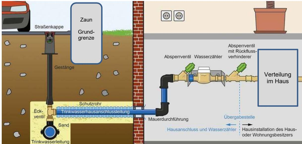
Der Hausanschluss wird in einer Tiefe von ca. 120 cm errichtet (frostsicher). Der Wasserzähler wird im Privatbereich installiert (entweder im Wasserzähler-Schacht bzw. im nächstgelegenen Kellerraum) und ist daher nur nach Voranmeldung für den Wasserwart zugänglich.
